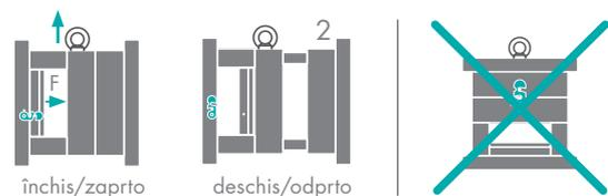
Înainte de a deschide matrița montată pe mașină, rotiți cârligul în poziția deschis (poz. 2).
