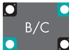
Distanțele dintre găurile de ghidare și marginile exterioare sunt identice pe diagonală. Se utilizează câte o pereche de plăcuțe de presiune de formele B și C.
